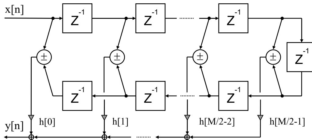
NOTA: dada a relação recíproca-conjugada entre os vários zeros de um sistema FIR de fase linear, é possível realizar estes sistemas como uma cascata de subsistema de 1<sup>a</sup>, 2<sup>a</sup> e 4<sup>a</sup> ordem, cada um deles de fase também linear.
